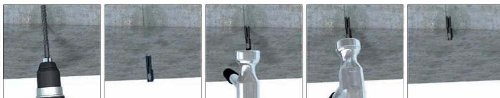
Si raccomanda un'accurata pulizia del foro prima dell'installazione.
