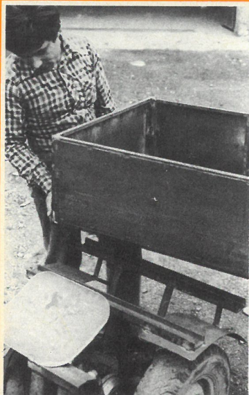
La posa del cassone sui suoi supporti. Esso deve essere imbullonato per consentirne lo smontaggio al fine di accedere al motore per i lavori di manutenzione. Notare l'intelaiatura della sponda posteriore smontabile, perché scorrevole dentro 2 guide di piattina.
