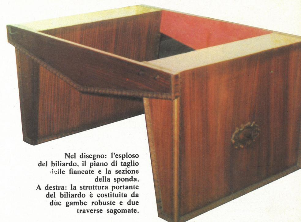
Nel disegno: l'esploso del biliardo, il piano di taglio delle fiancate e la sezione della sponda. A destra: la struttura portante del biliardo è costituita da due gambe robuste e due traverse sagomate.
