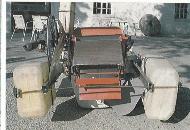
La ruota a 4 pale, in ferro saldato. È munita di un paraspruzzi superiore, a cuffia, e di due paraspruzzi laterali, in modo da convogliare la schiuma che viene prodotta in grande quantità.
