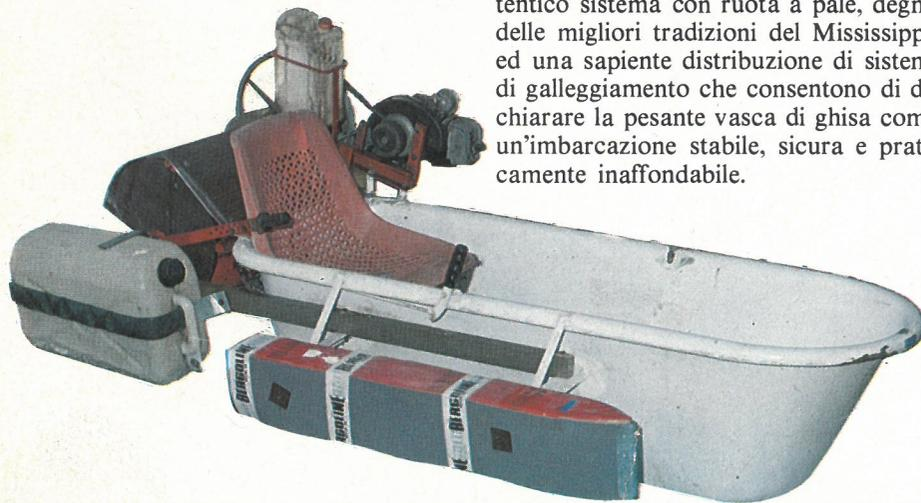
La prima cosa da fare, dopo che la vasca è pervenuta nelle nostre mani, è quella di saldare due piastrelle metalliche dall'esterno (dall'interno la presenza dello smalto complica un po' le cose) per otturare definitivamente lo scarico superiore del «troppo pieno» mentre il foro di scarico principale deve essere sostituito da un foro d'aleggio, ossia da un piccolo tappo a vite, della massima sicurezza, posto all'interno e saldato al centro della seconda piastrina.
