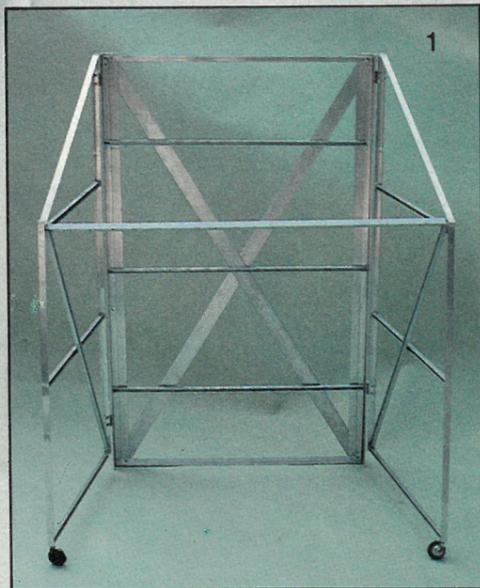
1: il telaio che sorregge la copertura è realizzato con profilato d'alluminio. I due fianchi sono incernierati al fondo e sono montati su rotelle per poterli richiudere agevolmente.
