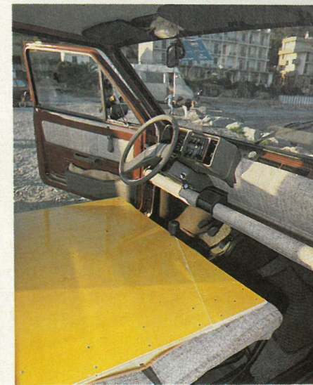
8 Il pianale anteriore appoggia sui sedili anteriori reclinati e sul bordo anteriore del pianale posteriore. La leva del cambio deve essere posizionata sulla prima marcia.
