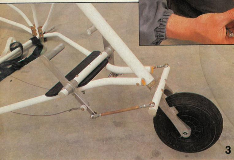
3: la ruota anteriore e il timone posteriore si comandano facilmente con 2 pedali posti ai piedi del sedile di pilotaggio.
