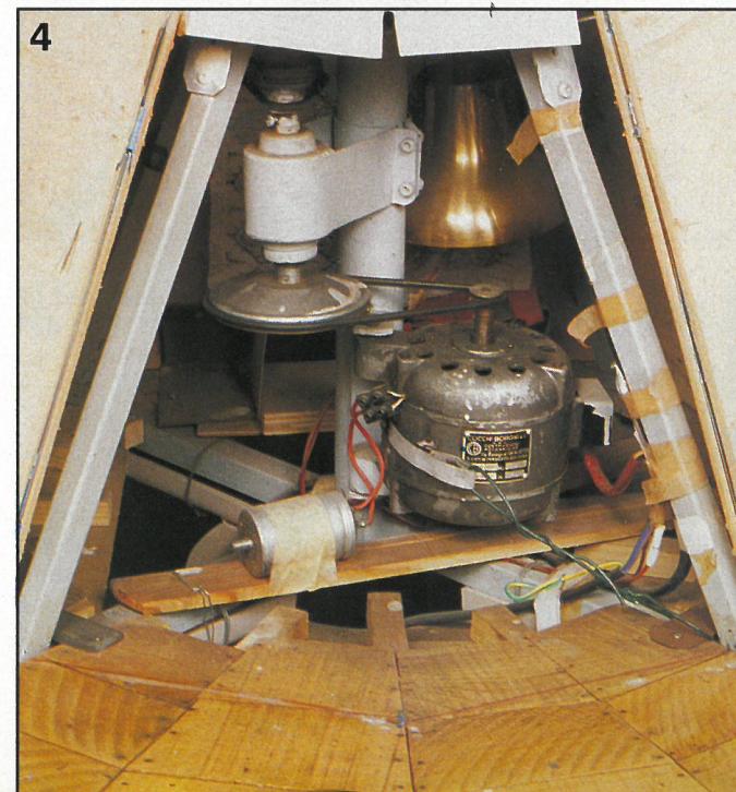
4: pali d'antenna e tubo quadro formano la struttura della giostra azionata da un motore da lavastoviglie fortemente demoltiplicato; in secondo piano la campana che segna automaticamente l'inizio e la fine di ogni corsa. Perfino la piattaforma è resa realistica dalla lavorazione a settori.
