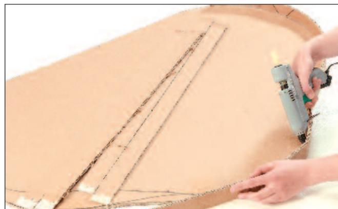
Col resto delle strisce si realizza, incollandole di coltello una di fianco all'altra, la tamburazione che dà al piano la rigidità necessaria. La distanza fra le strisce dipende dal tipo di cartone usato, maggiore per il doppia onda, minore per l'onda singola.
