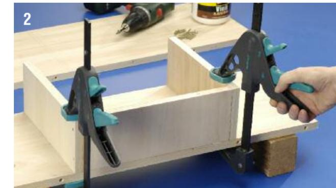
Lo sbalzo di 5 mm osservato per la costruzione della seduta va rispettato anche per i braccioli. Vanno infatti spinati alla seduta rientrati di 5 mm, mentre i tre elementi superiori che costituiscono la copertura devono sporgere di 5 mm, su due lati quello centrale e su tre quelli anteriore e posteriore. La struttura del bracciolo è larga 150 mm, in modo da avere una luce interna di 114 mm per disporre i libri; i pannelli di copertura sono larghi 160 mm.
